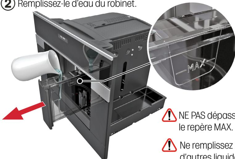
⚠ Ne remplissez le réservoir qu'avec de l'eau froide. N'utilisez jamais d'autres liquides comme de l'eau minérale ou du lait.
