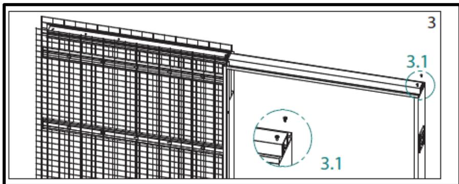
**Etape N°3** - Positionner le montant opposé (C) et le bloquer en vissant avec les vis fournies (N° 2 vis à tête Ø4,8x17) (Part. 3.1).
