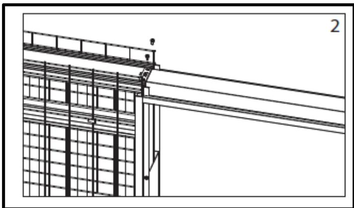
**Etape N°2** - Bloquer la traverse du Rail (A) en vissant la languette avec les 2 vis fournies (N° 2 vis à tête Ø3,9x13)
