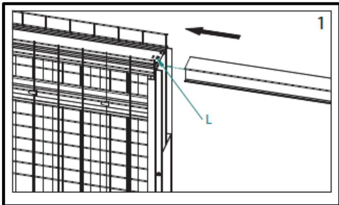
**Etape N°1** - Insérer la traverse du rail (A) à l'intérieur du caisson jusqu' au blocage de la languette (L)
