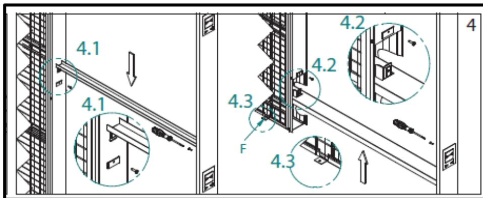
**Etape N°4** - Fixer l'entretoises (B1 et B2) avec les 2 vis fournies (N° 4 vis à tête Ø4,8x17) nécessaires pour maintenir la largeur de passage (Part 4.1 et 4.2).
